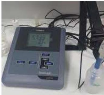
Gambar 1. Alat Ukur pH meter
