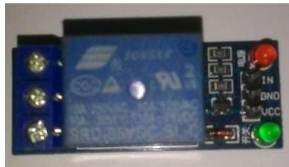
Gambar 13. Relay Module
