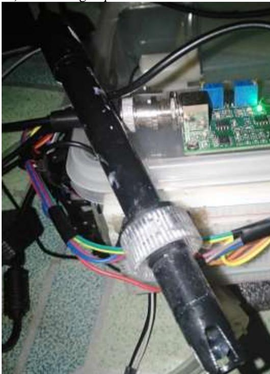
Gambar 15. Pemasangan pH Sensor
